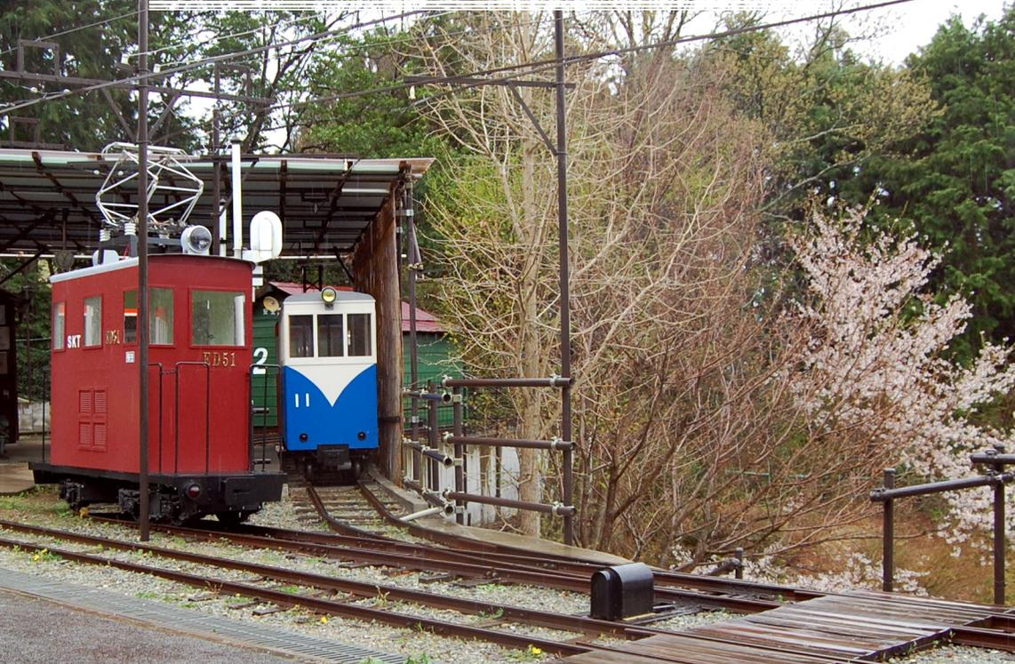
桜谷軽便鉄道南山線は軌間 381mm (15 インチ)、直流 30V の電化路線です。電車・電気機関車はポールカパンタグラフで架線集電し、直流モーターを駆動しています。バッテリー機関車は自動車用バッテリー搭載です。ガソリン動車は市販のガソリン発電機を搭載し、交流電気を整流して直流モーターを駆動しています。蒸気機関車は小型の石炭焚きボイラーで発生させた蒸気でエンジンを駆動しています。
